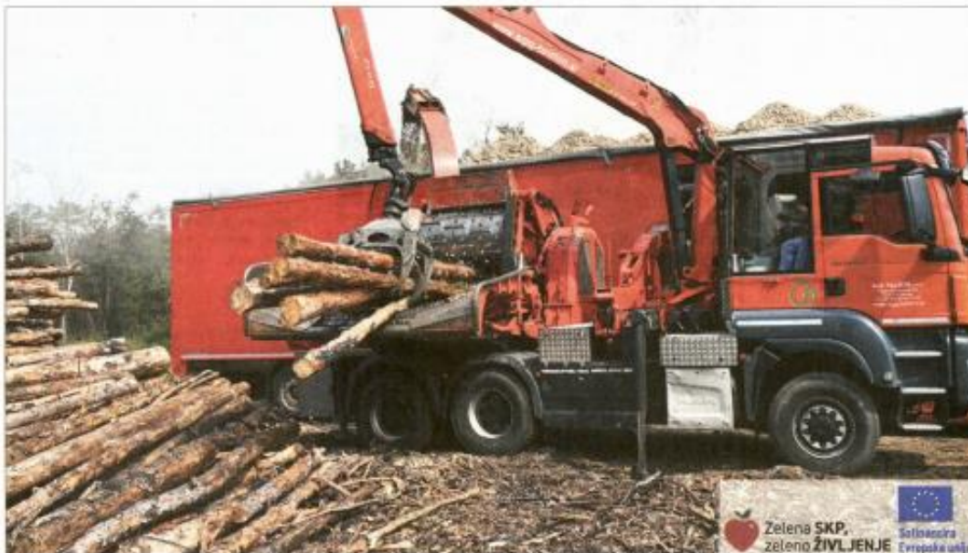
Mletje poškodovanega lesa
